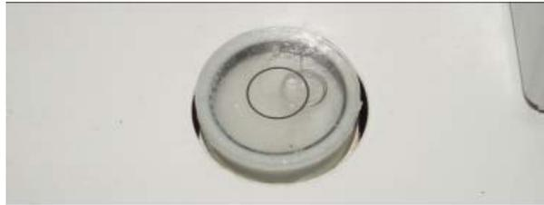
图 7：水平指示装置
